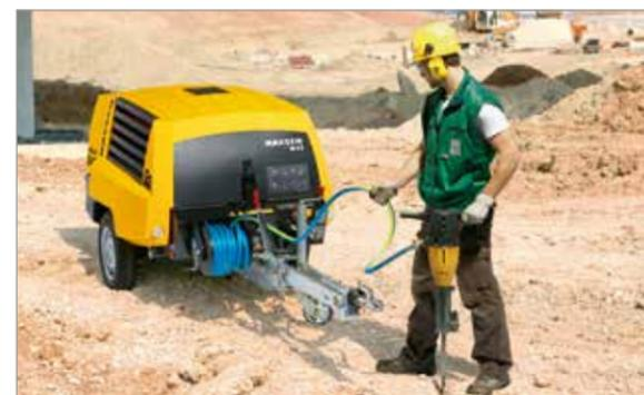
Les compresseurs de chantier MOBILAIR dans la plage de débit de 2 à 5,6 m³/min ne craignent pas le froid : la régulation antigel brevetée KAESER adapte automatiquement la température de service des machines à la température ambiante. En combinaison avec le graisseur de ligne disponible en option, elle protège les outils pneumatiques contre le gel et augmente leur disponibilité et leur longévité.
