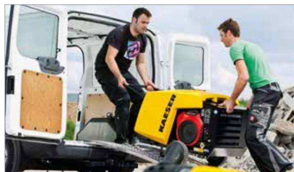
Les plus petits compresseurs MOBILAIR alimentent en air comprimé les bèches, marteaux, perceuses, scies, tournevis et ponceuses pneumatiques ou les fusées souterraines. La version à 15 bar est parfaite pour les tests d'étanchéité ou la pose de fibres optiques par portage à l'air. Un refroidisseur final d'air comprimé externe, proposé en option, permet d'obtenir de l'air comprimé frais et sans condensats, et une chaîne de filtration externe est proposée pour de l'air comprimé sans huile.
