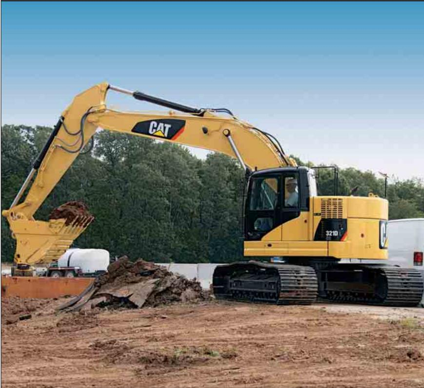
**Faible rayon arrière.** Le faible rayon arrière de la 321D LCR la rend idéale pour les travaux dans les espaces restreints, notamment à proximité de bâtiments, sur les chantiers routiers (limitant la fermeture de voies de circulation) ou sur les pistes forestières. L'encombrement arrière n'est que de 1680 mm, contre 2750 mm sur la 320D. Lorsque la machine travaille latéralement, avec un pivotement de 90 degrés, le contrepois dépasse à peine des chaînes.
